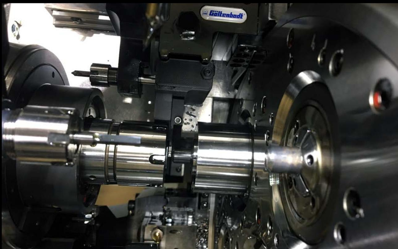
Il nuovo sistema di troncatura G80A è dotato di caratteristiche che offrono migliori prestazioni, maggiore affidabilità ed efficienza. Il passaggio interno di refrigerante rende il processo ancora più sicuro, garantendo una durata dell'utensile superiore.
