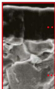
Grado con rivestimento PVD per un'ampia gamma di applicazioni. La combinazione di uno speciale substrato in metallo duro cementato tenace, con il rivestimento MIRACLE, assicura un eccellente bilanciamento di resistenza all'usura e resistenza alla scheggiatura.
