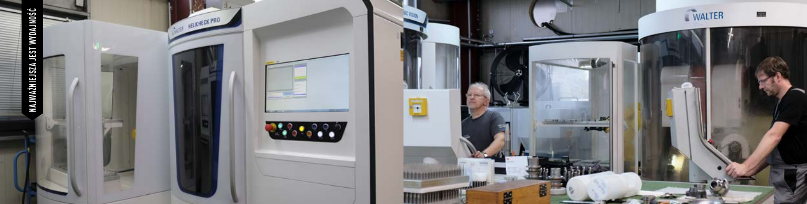
Maszyna pomiarowa Helicheck Pro do w pełni automatycznych pomiarów narzędzi
