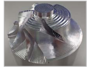
İşleme sırasında kırılma
