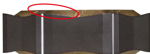
Pochylona krawędź skrawająca i duży kąt natarcia
