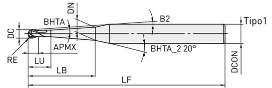
Fresa integrale conica a testa semisferica a 3 tagli con rivestimento in diamante per la lavorazione di grafite.
