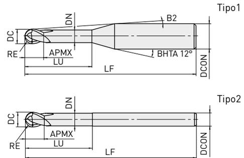
Fresa integrale a testa semisferica a scarico lungo,
